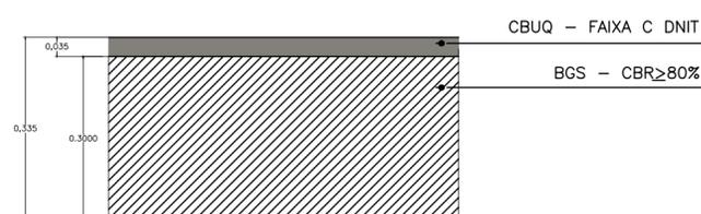
**2** DETALHE - ESTRUTURA DO PAVIMENTO
