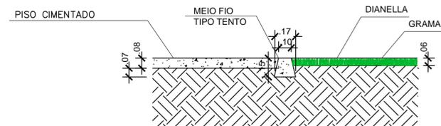
DETALHE PISO EM CONCRETO X GRAMADO ESC 1/25
