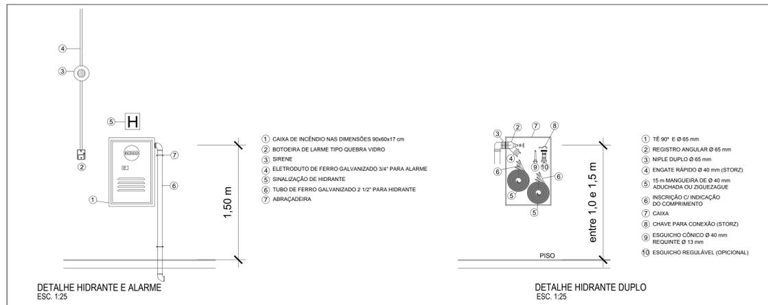
DETALHE HIDRANTE E ALARME
